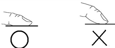
ポイント2： センサー面の輪郭（くぼみ）に合わせて指を置いてください。
